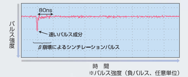
図2 β崩壊によるシンチレーションパルス例
